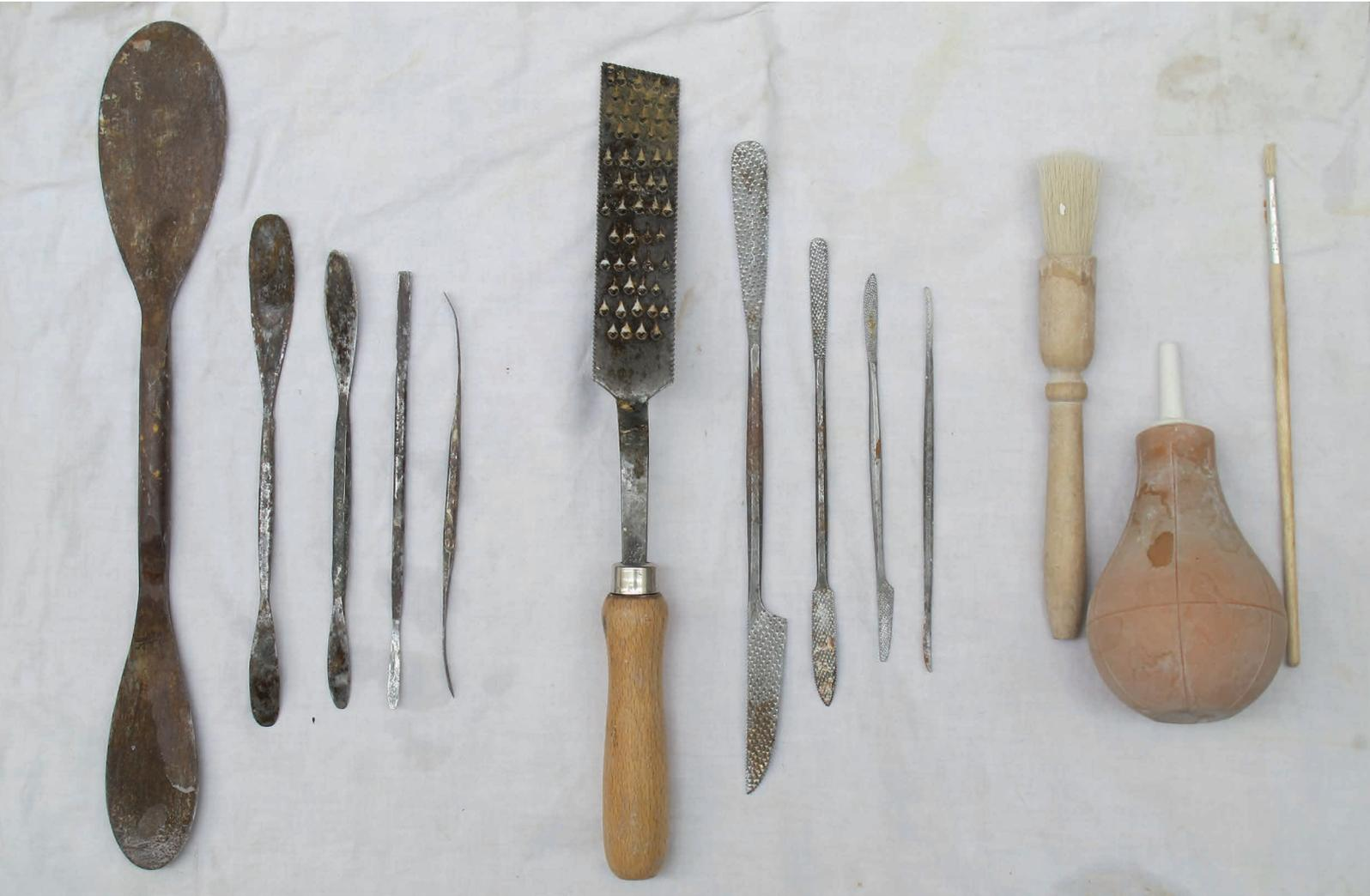
Abb. 03: Bildhauerwerkzeug; linke Gruppe: Modellierspachtel (zum Teil mit Schnitzklingen), mittlere Gruppe: Raspeln, rechte Gruppe: Pinsel und Klistierspritze zum Entfernen des leichteren Raspelstaubes
